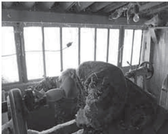
F. Loučka profukuje hlavici dýmky (tabákovou komoru s kouřovým kánalem) po základním vysoustružení. Foto L. Kafka 2004.
