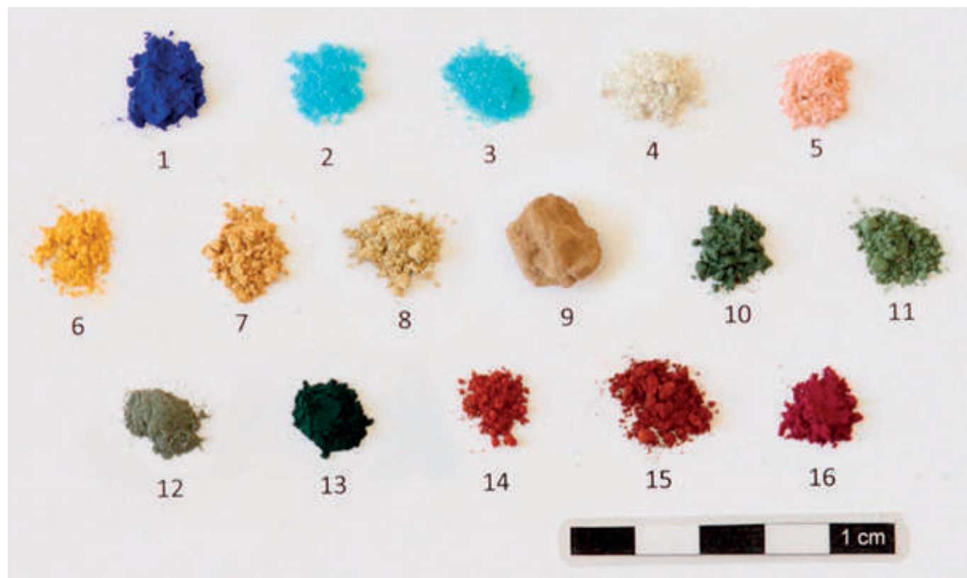
Obr. 4. Fotodokumentace analyzovaných vzorků. Vzorek 9 je tvořen hrudkami, které pravděpodobně vznikly vlivem vlhkosti, ostatní vzorky jsou sypané prášky. Foto Dalibor Všianský 2022
